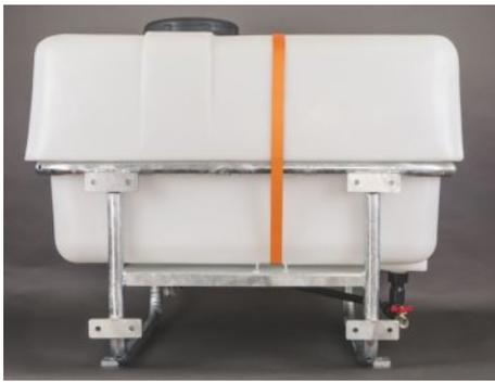
Diese Sprayeranlagen Basic 200 l bestehen aus einem propionsäurebeständigen Kunststofftank. Flüssigkeitsentnahme unten mit Dreiweghahn mit Anschluss für Behälterentleerung. Ausbringmenge / Dosierung bis 8,3 l/min Flüssigkeit. Einstellbar, stufenlos über Drehzahlsteller. Mengenkontrolle über Manometer oder Digital ablesbar. Halterungsrahmen in verzinkter Ausführung. Leicht an jeder beliebigen Maschine zu montieren. Spritzbalken mit zwei Düsen.
