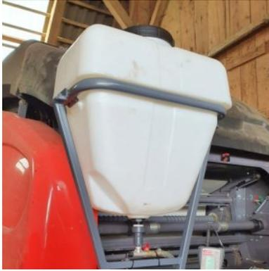
Diese Sprayeranlagen Basic hoch Comfort bestehen aus einem propionsäurebeständigen Kunststofftank. Flüssigkeitsentnahme unten mit Dreiweghahn mit Anschluss für Behälterentleerung. Ausbringmenge / Dosierung bis 8,3 l/min Flüssigkeit. Einstellbar, stufenlos über Drehzahlsteller. Mengenkontrolle über Manometer oder Digital ablesbar. Halterungsrahmen in verzinkter Ausführung. Leicht an jeder beliebigen Maschine zu montieren. Spritzbalken von Hardi mit zwei Düsen
