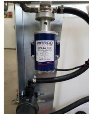
Diese Eco Sprayeranlagen bestehen aus einem propionsäurebeständigen Kunststofftank. Flüssigkeitsentnahme unten mit Dreiweghahn mit Anschluss für Behälterentleerung. Ausbringmenge / Dosierung bis 8,3 l/min Flüssigkeit. Einstellbar, stufenlos über Drehzahlsteller. Mengenkontrolle über Manometer. Halterungsrahmen in verzinkter Ausführung. Leicht an jeder beliebigen Maschine zu montieren
